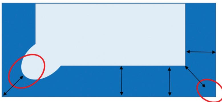
Épaisseur réduite du matériau, pour plus de luminosité dans l'angle.
